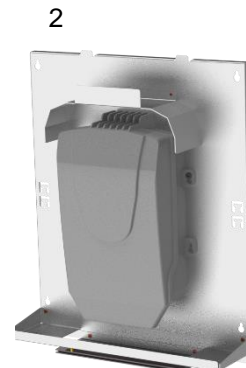
2 Monter BUDI-boksen på bagpladen. Kør overlængde på kablerne rundt om kabelholderne. Evt. aflastning med strips/velcro kan laves i begge sider. Der er stor kabelgennemføringshul i bunden og 2 mindre i hver side af toppladen.
